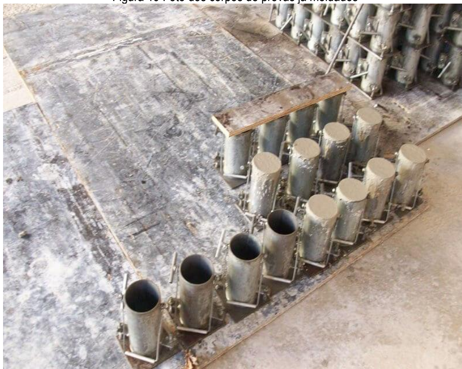
Figura 19 Foto dos corpos de provas já moldados
