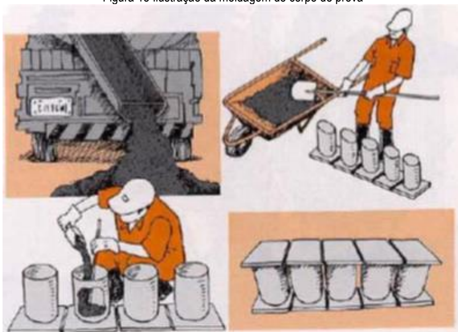
Figura 18 Ilustração da moldagem do corpo de prova
