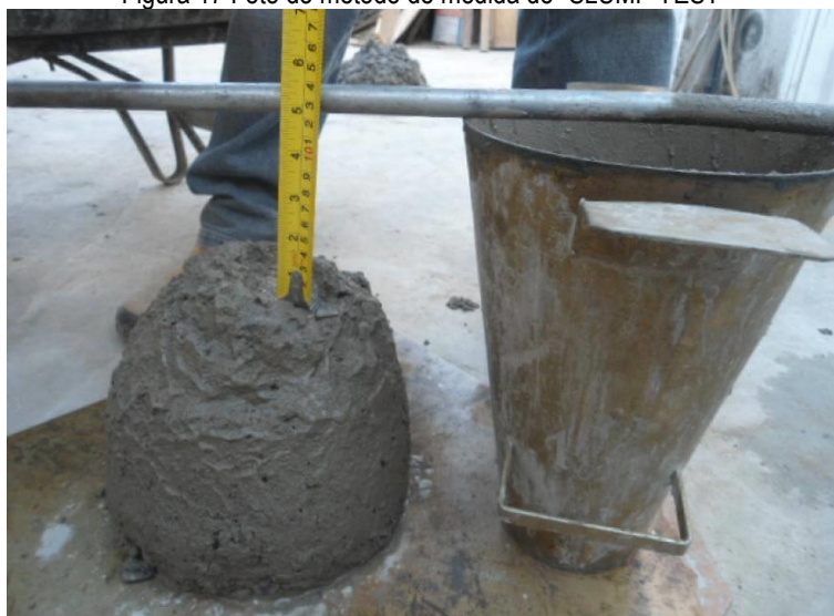
Figura 17 Foto do método de medida do "SLUMP TEST"
